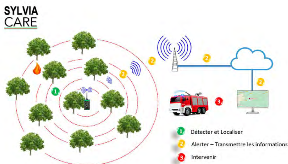
Rayonnement Infra rouge généralisé par le départ de feu et analysé par le capteur
